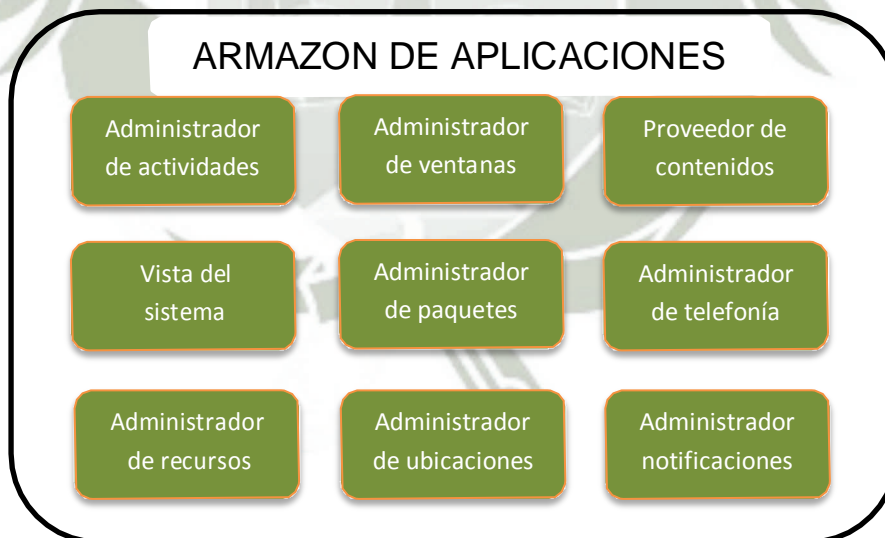
Ilustración 5 Estructura de aplicaciones
