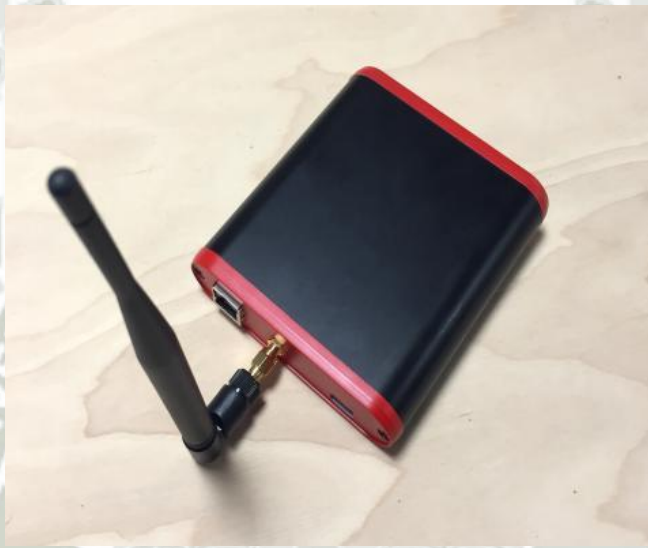
Figura 3. 10 Enrutador de frontera inRout Fuente: http://zolertia.io/
