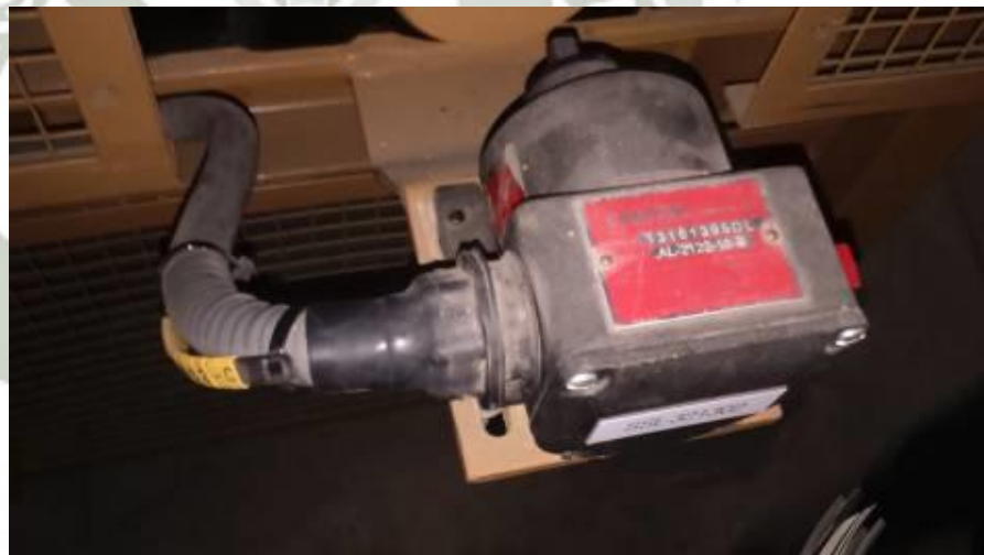
Imagen “27”: Velocidad Cero en Belt Conveyor (Creación Propia).
