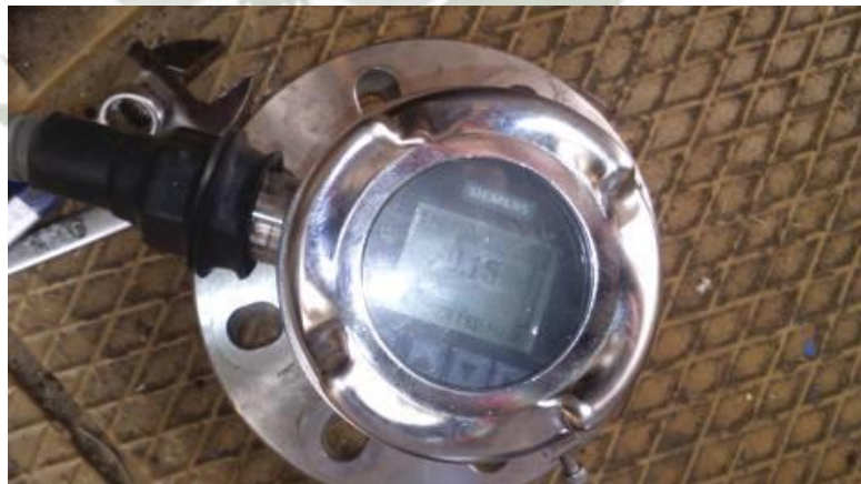
Imagen “33”: Transmisor de Nivel en Tolva (Creación Propia).
