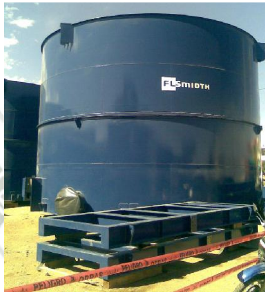
Imagen "3": Fabricación Estructural (Celda de Flotación).
