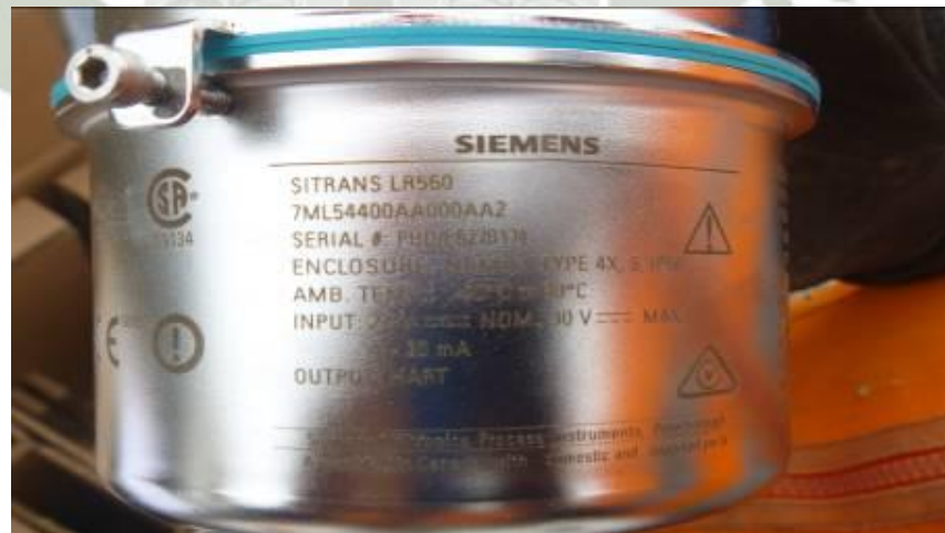
Imagen "34": Transmisor de Nivel tipo Radar HART (Creación Propia).
