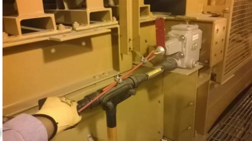
Imagen “25”: PullCord en Belt Feeder (Creación Propia).
