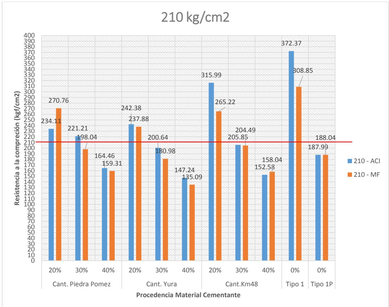
GRÁFICA 33 Comparativa de resistencia a la compresión para concretos  $f_c$  210 kg/cm<sup>2</sup> (Fuente propia)
