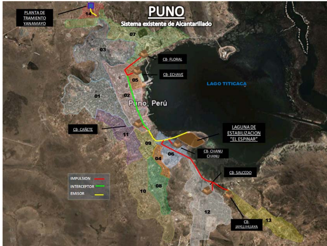
GRAFICO 02 ESQUEMA DEL SISTEMA DE ALCANTARILLADO SANITARIO
