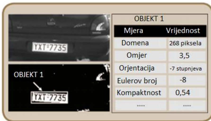
Slika 8. Oblik analize u binarnom objektu[13]
