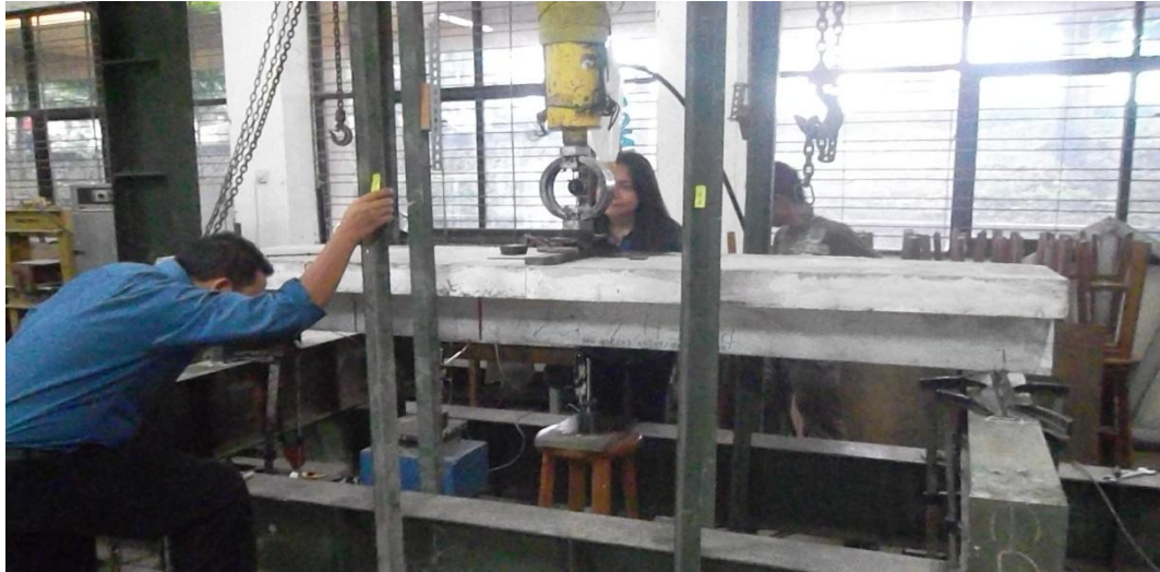
Gambar 4.13 Pengujian Kuat Lentur Balok Dengan Jarak Sambungan (1/4) A
