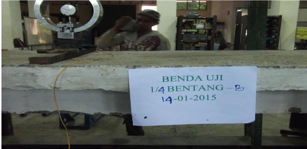
Gambar 4.16 Pengujian Kuat Lentur Balok Dengan Jarak Sambungan (1/4) B
