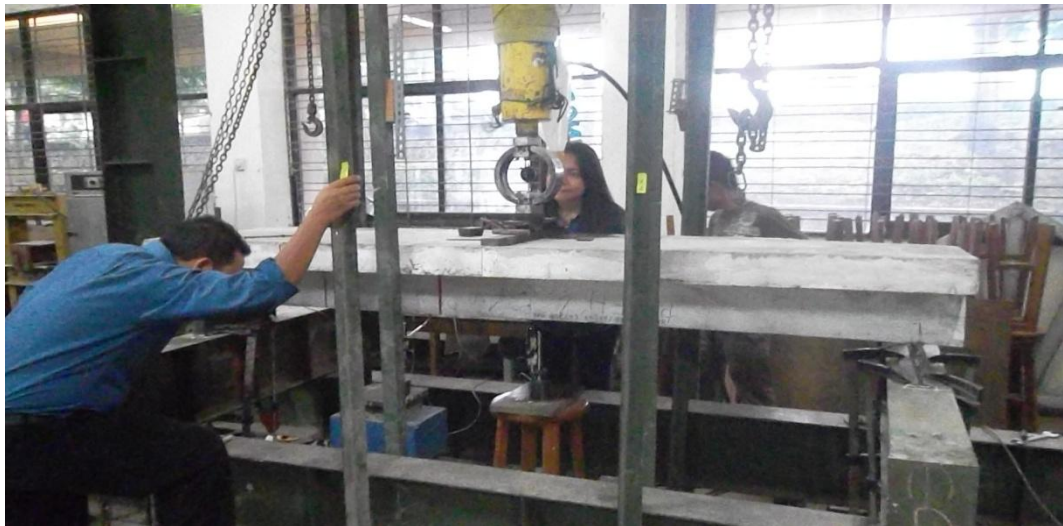
Gambar 4.23 Pengujian Kuat Lentur Balok Dengan Jarak Sambungan (1/4) A
