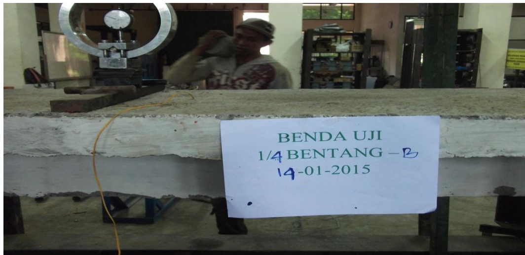
Gambar 4.26 Pengujian Kuat Lentur Balok Dengan Jarak Sambungan (1/4) B
