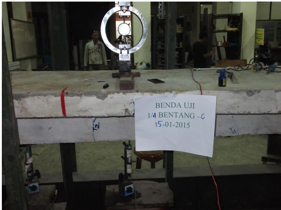
Gambar 4.29 Pengujian Kuat Lentur Balok Dengan Jarak Sambungan (1/4) B
