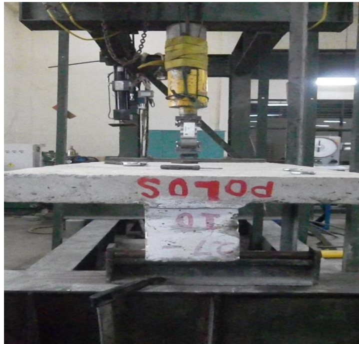
Gambar 4.2 Pengujian Benda Uji Balok Tanpa Sambungan A ( BTS – A )
