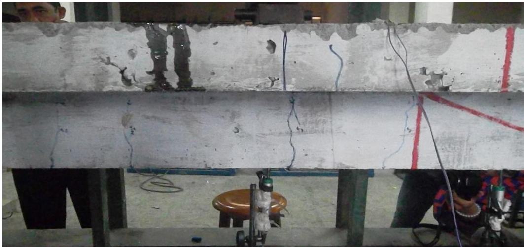
Gambar 4.14 Pola Retak Balok T Dengan Jarak Sambungan 1/4 ( A )
