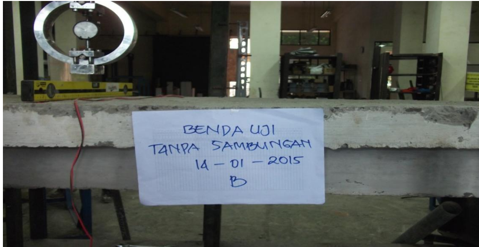
Gambar 4.5 Benda Uji Balok T Tanpa Sambungan Beton dan Tulangan B ( BTS-B )
