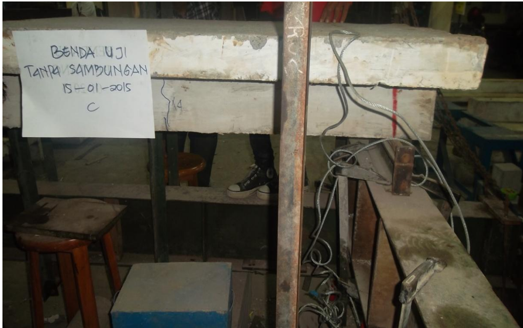
Gambar 4.8 Benda Uji Balok T Tanpa Sambungan Beton dan Tulangan C (BTS-C)
