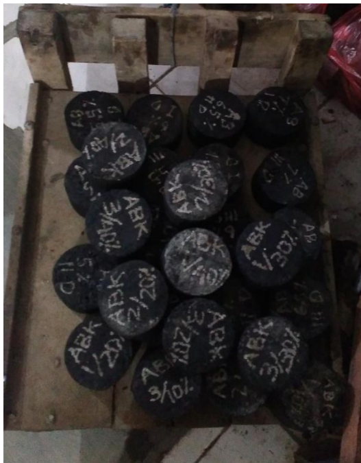
Gambar 28. Beton aspal yang telah selesai dilakukan pengujian
