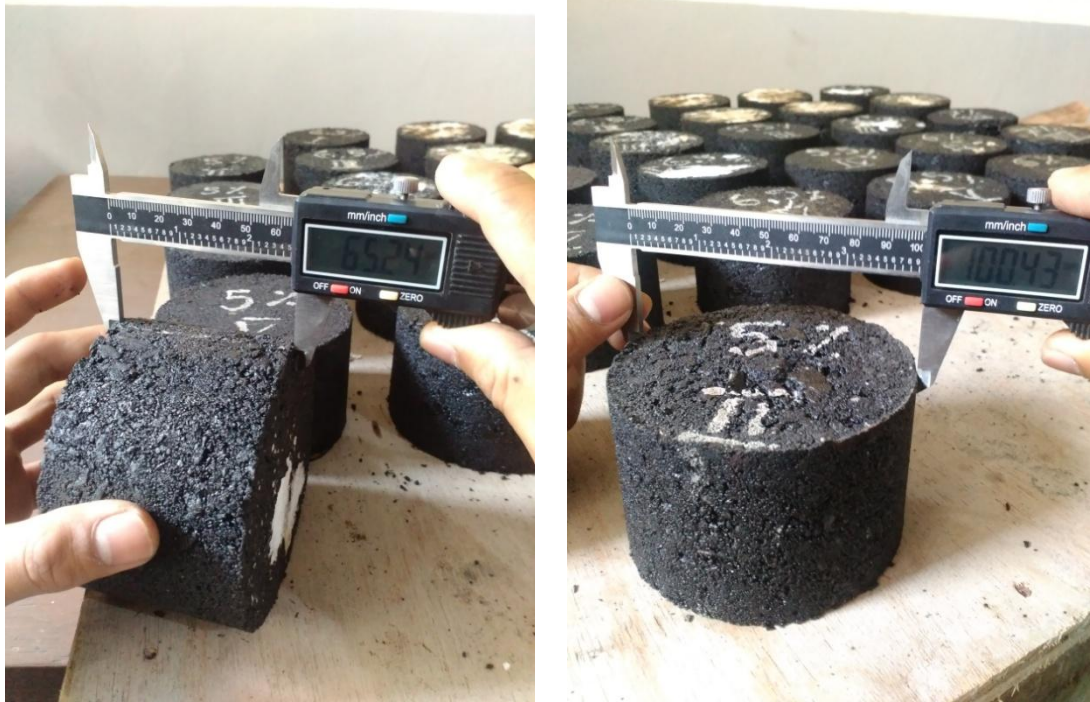
Gambar 21. Pengukuran ketebalan dan diameter dari beton aspal AC – WC dengan menggunakan jangka sorong
