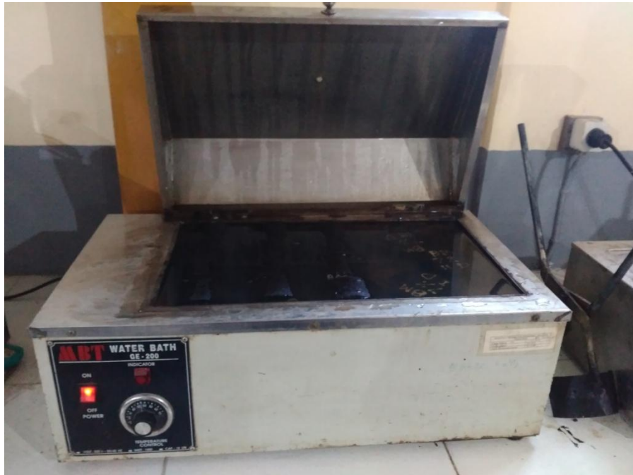
Gambar 26. Beton aspal yang sedang direndam dalam water bath pada suhu 60°C selama 30 menit
