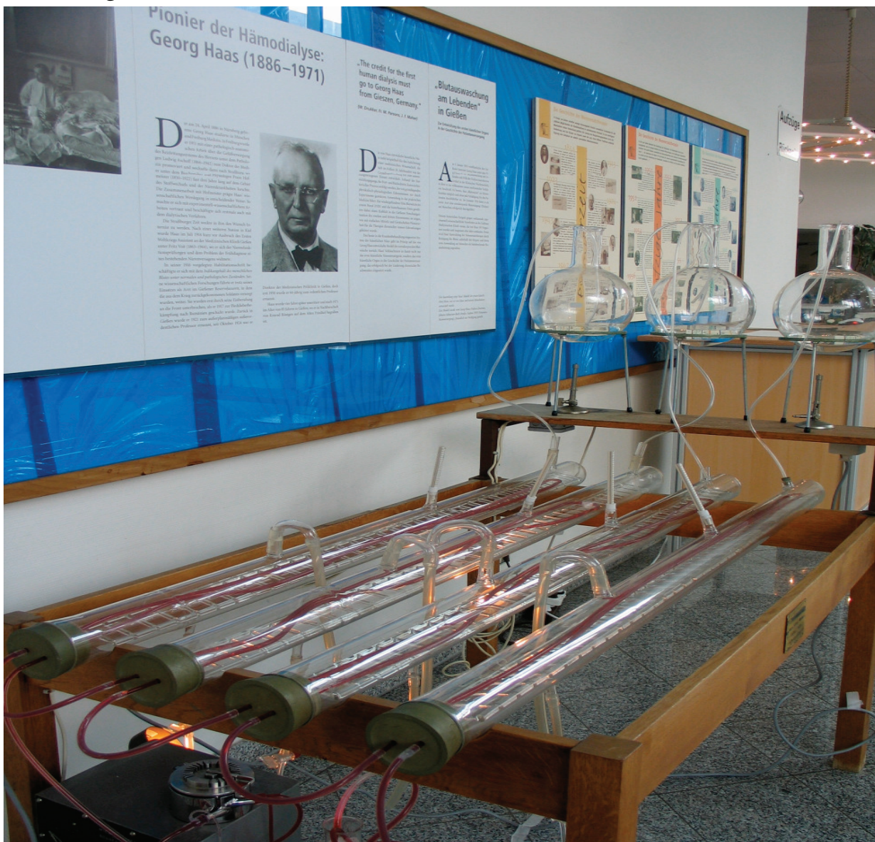
Abb. 5: Nachbau der von Georg Haas entwickelten künstlichen Niere. Der Internist Georg Haas hatte in Gießen 1924 die erste Blutwäsche am Menschen weltweit durchgeführt, sein Dialysegerät wurde von Technikern und Nephrologen nachgebaut und vom Georg-Haas-Dialysezentrum dem Fachbereich Medizin für die Dauer der Ausstellung freundlicherweise zur Verfügung gestellt. Fotografie: Dagmar Klein, Wetztenberg.
