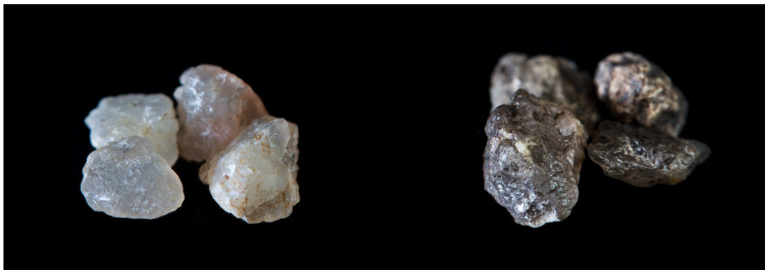
Abb. 4.27: Makro-Aufnahme vom Inhalt der Knallerbsen vor (links) und nach der Reaktion (rechts)
