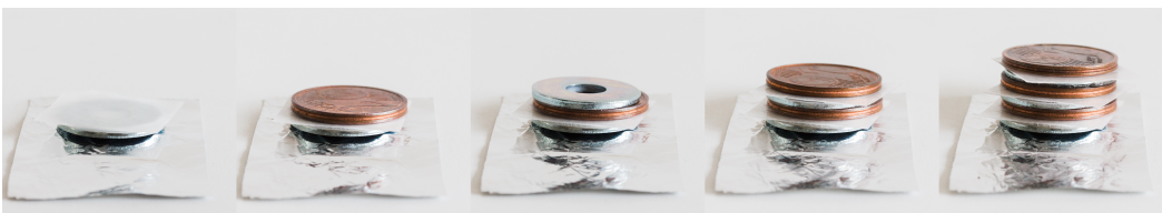
Abb. 4.21: Selbstbau einer Batterie aus Unterlegscheiben und Euro-Cent-Münzen
