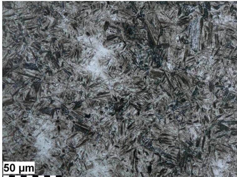
**Abbildung 61:** Gefügebild im Kern eines Zylinders ( $\varnothing$  29,5 mm) des Stahls 42CrMo4 nach Abschreckung in der Ionischen Flüssigkeit [EMIm][NTf<sub>2</sub>] (Probe 3) (Ätzung mit Nital [92]).
