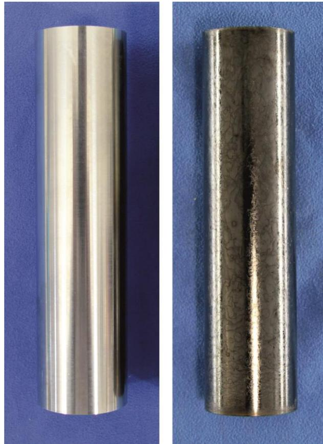
**Abbildung 66:** Probenoberfläche eines Zylinders (Länge 120 mm) vor (links) und nach (rechts) Abschreckung in [EMIm][EtSO<sub>4</sub>].
