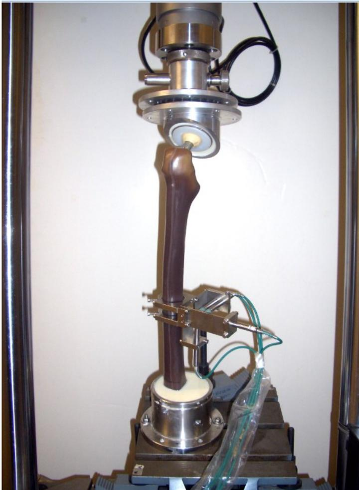
Abb. 3.4. Aufbau der Prüfvorrichtung mit Composite-Femur und angelegter Haltevorrichtung mit den LVDTs (s. auch Abb. 3.9.).
