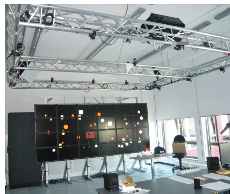
(b) Trackingbereich mit IR-Kameras am hängenden Traversensystem
