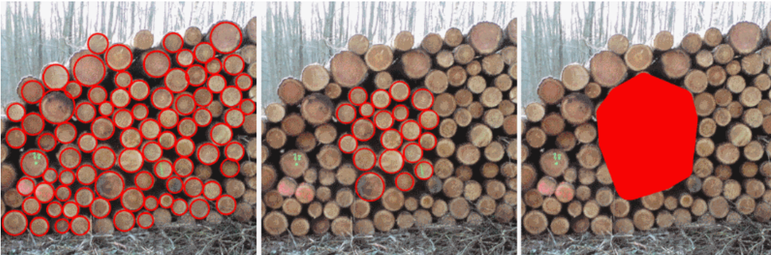
Abbildung 3.31: Die Zwischenschritte zur Bestimmung des inneren Schnittholzbereiches: Von links nach rechts sind CP^v , die inneren Kreise und der innere Bereich zu sehen.
