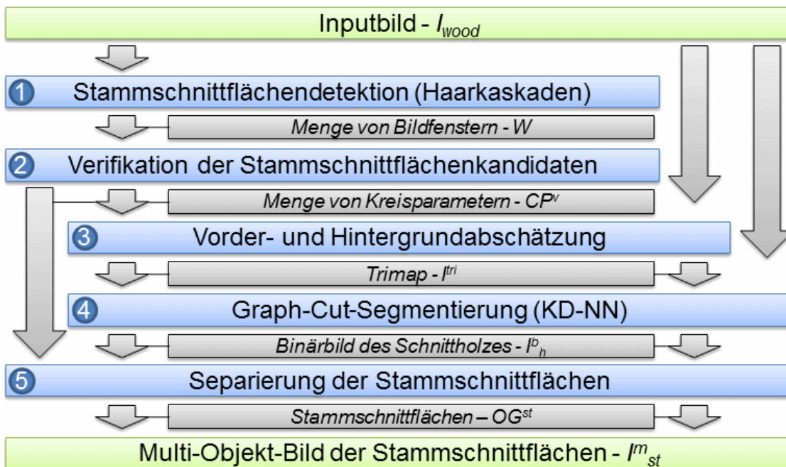
Abbildung 3.30: Grobes Konzept zur Segmentierung der Stammschnittflächen durch Objektdetektion und Graph-Cut.
