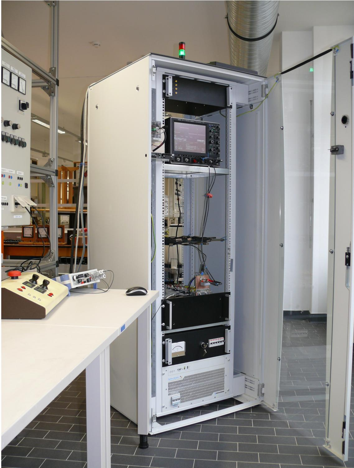
**Abbildung A.3.:** Prüfstand im Labor, mit WaveSurfer 104 MXs-A zur Messung des CMF20120D
