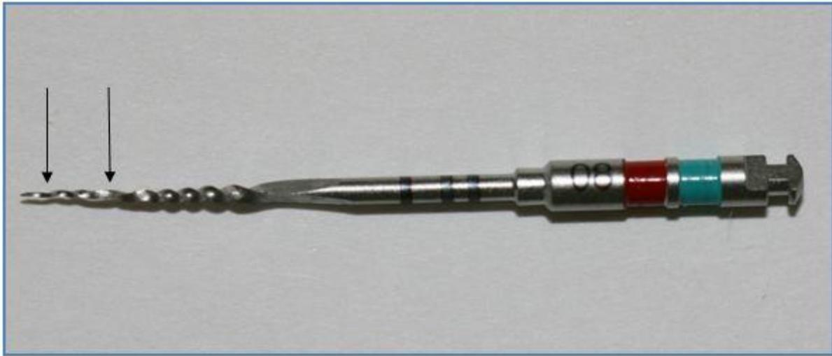
Abb. 24: Deformation eines TF Instruments 25/.08 (Pfeile)
