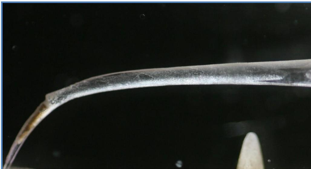
Abb. 23: Fraktur eines ES-Instruments 25/.06 in Block Nr. 6
