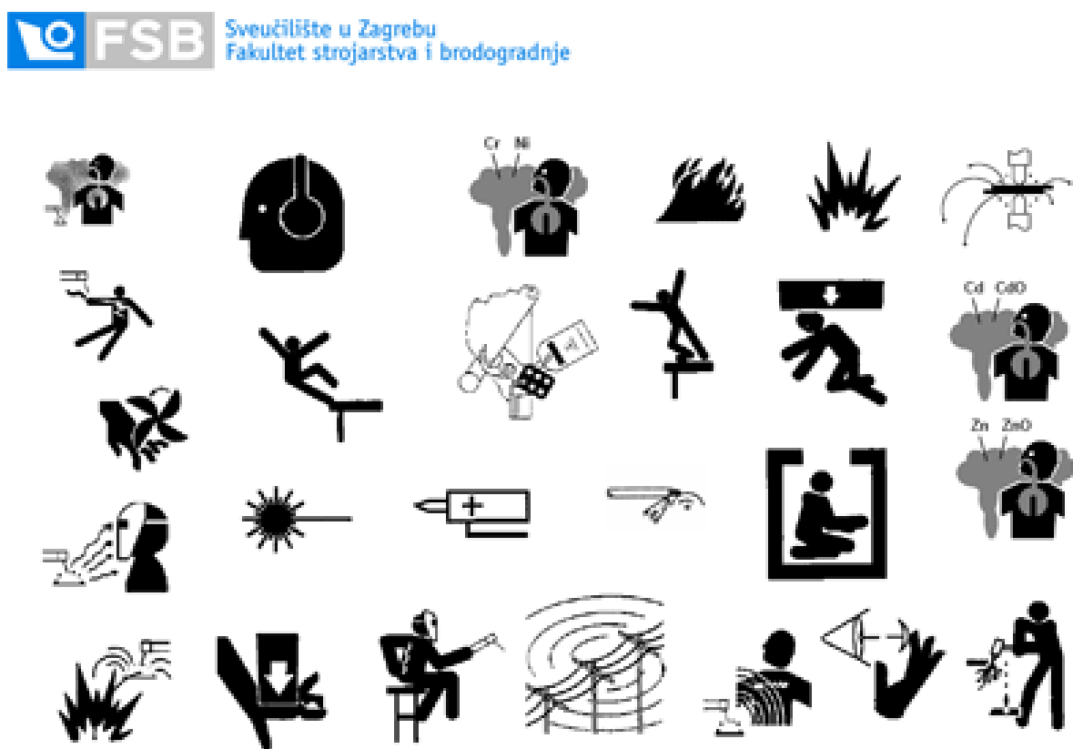
Slika 4. Mjere opreza kod ručnog zavarivanja
