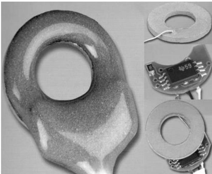
*Abb. 6: aktive ringförmige Silberchlorid-Oberflächenelektrode*
