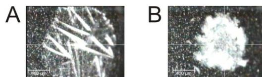
**Abbildung 47 A:** Präparation mit 1  $\mu$ l 5 mg/ml DHB auf einem Anchor Target. **B:** Präparation mit 0,3  $\mu$ l THAP-Lösung (10 mg/ml) mit darauffolgender Präparation von 1  $\mu$ l der 5 mg/ml DHB-Lösung; Balken entspricht einer Länge von 400  $\mu$ m (Eickner, Mikkat et al. 2011).
