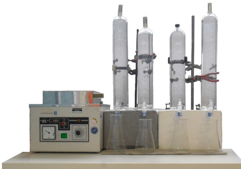
Abb. 2.1: Modifizierte 1000-ml-Glaszylinder zur Bestimmung der Gesamtgasmenge. Die aus vier modifizierten 1000-ml-Zylindern bestehende Gasmessapparatur wurde über Schläuche mit den 100-ml-Batch-Kulturen von C. acetobutylicum verbunden. Die Inkubation der Kulturen erfolgte im Wasserbad bei 37 \text{ }^\circ\text{C} (aus UHLIG, 2011).
