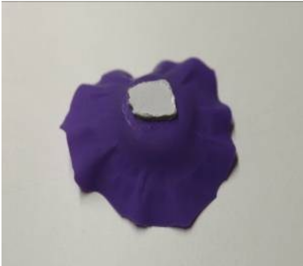
Abbildung 57: Membran mit simuliertem Kalkplaque
