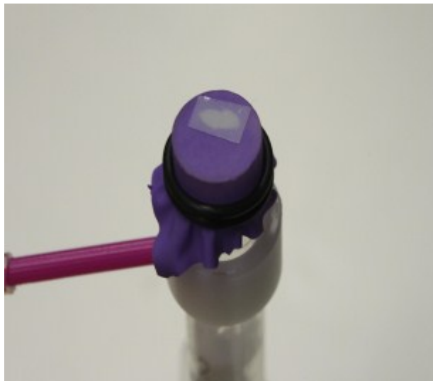
Abbildung 58: Membran mit simulierter Perforation
