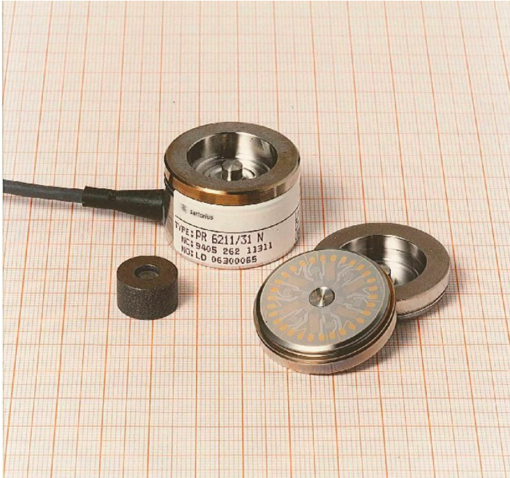
Abbildung 18: Wägezelle mit fest fixierten DMS
