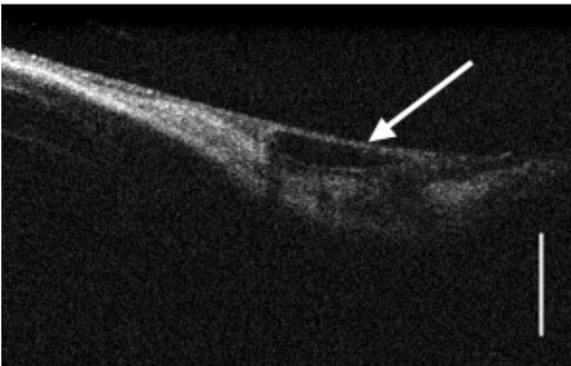
Abbildung 41: Optische Kohärenztomografie - Trommelfell mit aufgelegtem DMS nach Druckausgleichsmanöver
