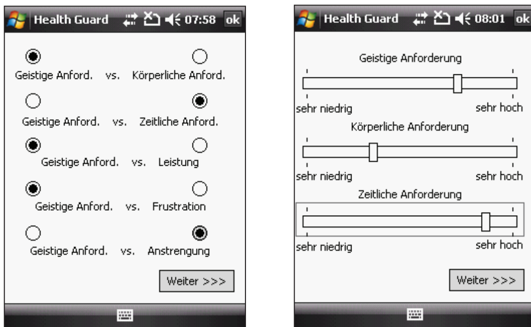
Abbildung 5-14: Dialog mit dem NASA-Task Load Index; links: Gegenüberstellung der Subskalen (Ranking); rechts: Einzeleinschätzung der sechs Subskalen (Rating).
