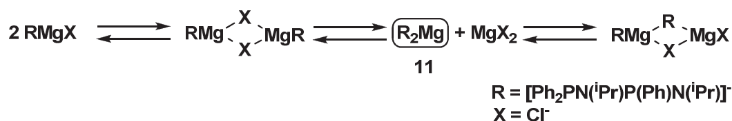
Abbildung 27: Schlenkgleichgewicht inklusive der isolierten Verbindung 11 .
