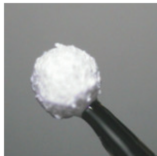
Abbildung 56: Harz-Kugel nach acht Katalyseversuchen, gequollen und überzogen mit einer Polymerschicht.
