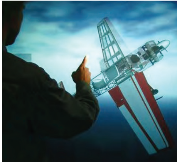
Abbildung 5.9: Selektion von Objekten in einer virtuellen 3D-Welt. Teilgeometrien des rotierbaren Flugzeugmodells sind mit Sensoren ausgestattet, über die die Transparenz der Außenhaut gesteuert wird.
