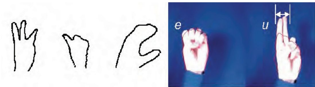
Abbildung 2.3: Erkennung von Buchstaben der Gebärdensprache American Sign Language , ASL. Das System verwendet ein Monokamerasystem und Farbinformation der Hand, um die Hand und deren Kontur vom Hintergrund zu trennen [BS02].
