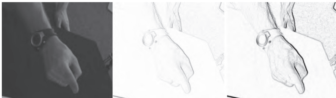
Abbildung 3.9: Kantenextraktion einer Zeigegeste. Original-Luminanzbild der aufnehmenden Kamera (links), Differenzenoperator (Mitte) und Sobel-Operator (rechts). Die Kantenbilder sind der besseren Sichtbarkeit wegen invertiert dargestellt.
