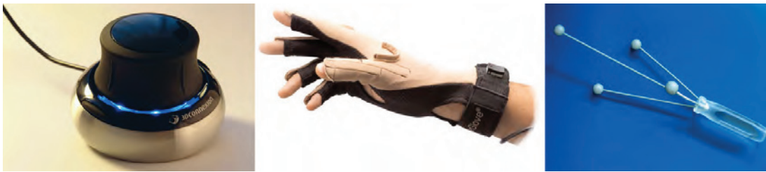
Abbildung 1.1: Klassische Eingabegeräte für die Interaktion mit VR-Welten: SpaceNavigator der Firma 3Dconnexion, CyberGlove II der Firma Immersion Corporation und Interaktiongerät für das Infrarot-Trackingsystem EOS [SM02].
