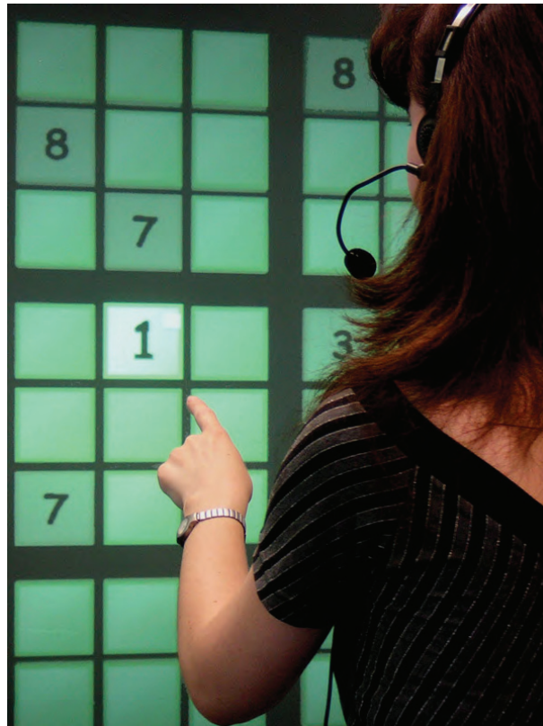
Abbildung 9.4: Sudoku-Spiel gesteuert durch multimodale Verknüpfung von Gesten- und Spracherkennung. Ein Spielstein ist durch die Zeigegeste aktiviert und mit der Zahl 1 gefüllt.
