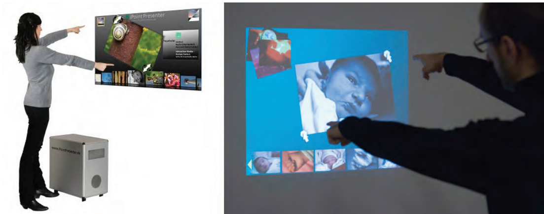
Abbildung 2.9: Der iPoint Presenter des Fraunhofer Instituts für Nachrichtentechnik, HHI in Berlin ermöglicht eine beidhändige Interaktion.
