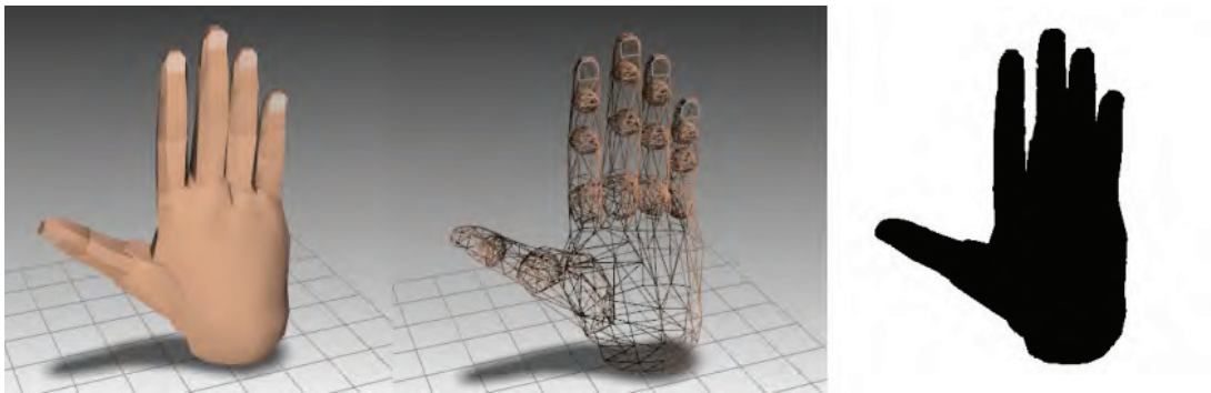
Abbildung 7.1: Zur Silhouettenerzeugung verwendetes X3D-Handmodell mit knapp 1600 Polygonen (von links: Flat Shading, Drahtgittermodell und invertiert binarisierte Silhouette).
