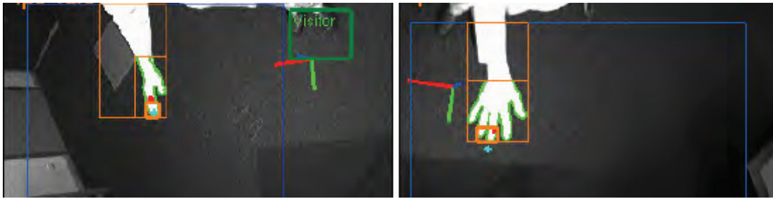
Abbildung 6.5: Kameransichten erzeugen unterschiedliche Merkmalsausprägungen. Insbesondere die Orientierung der Hand führt zu signifikant unterschiedlichen Ergebnissen in gleichzeitig aufgenommenen Bildern des Stereokamerasystems.
