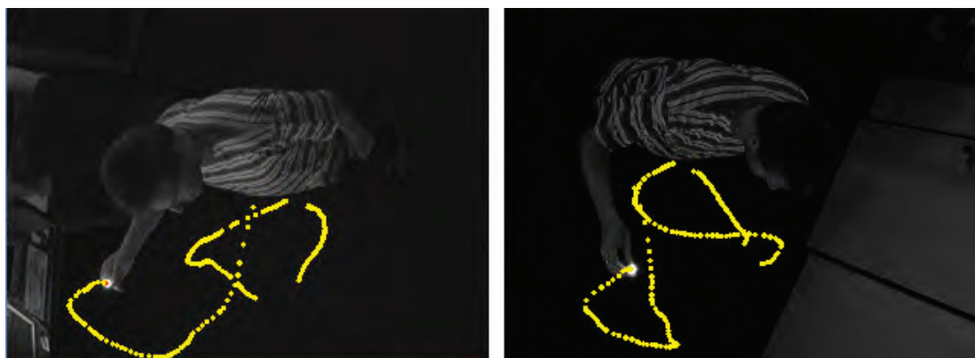
Abbildung 3.6: Aufzeichnung von Punktcorrespondenzen zur extrinsischen Kamerakalibrierung durch Segmentierung einer Leuchtdiode, die im Interaktionsraum geschwenkt wird. Bereits aufgenommene Punktpaare werden zu Kontrollzwecken durch Bildüberlagerung visualisiert.
