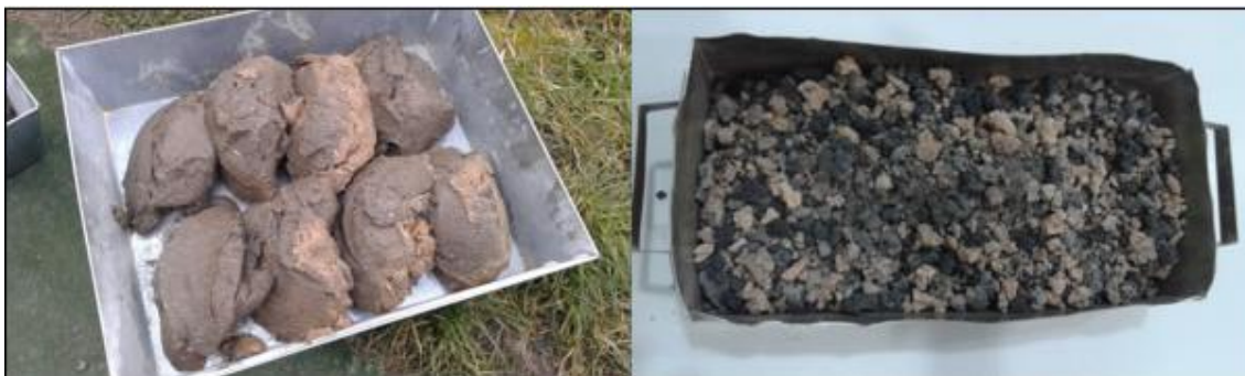
Slika 7. Mulj prije sušenja i spaljivanja u laboratoriju Građevinskog fakulteta u Zagrebu te granule dobivenog pepela
