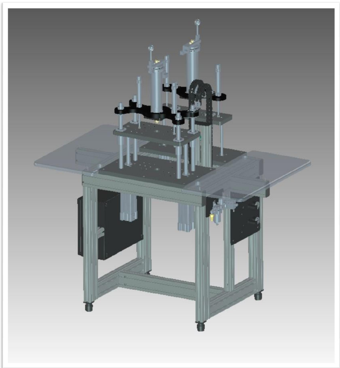
Slika 1.1. CAD model HotMelt uređaja
