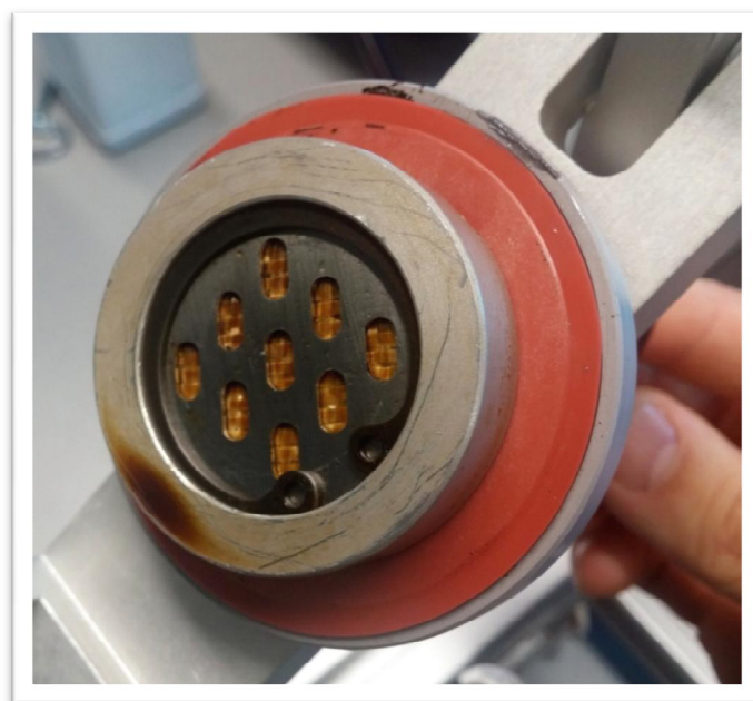
Slika 2.6. Unutarnji prikaz poklopca s filterom i brtvom
