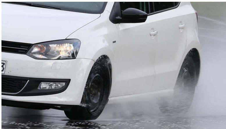
Slika 14. Primjer testiranja aquaplaninga, [24]
