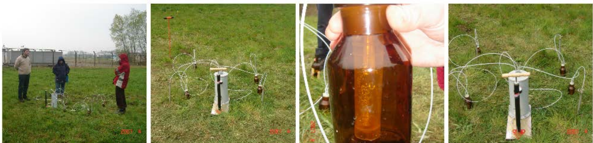
Slika 22 Sakupljanje otopine tla u polju pomoću keramičkih mikro usisnih čašica pogodnih za sakupljanje iona poput nitrata, klorida, sulfata, natrija, bromida (Zgorelec, 2007).
