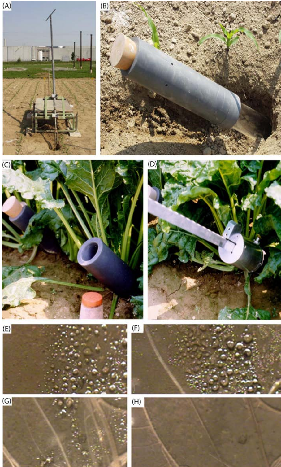
Slika 6 Postavljanje minirizotrona. (A) Platforma za bušenje tla; (B) Postavljanje minirizotrona pod kutem od 45° u blizini redova kukuruza; (C) Gornji krajevi minirizotrona u šećernoj repi prekriveni PVC kapticama i zabrtvljeni gumenim čepovima; (D) Mehanička ručica za pozicioniranje kamere; (E) Snimke korijena šećerne repe Beta vulgaris var. saccharifera nastale pomoću minirizotrona (600 dpi) na konstantnoj dubini (0,9 m) tijekom (E) 79 dana; (F) 92 dana; (G) 108 dana i (H) 176 dana nakon sjetve (Vamerali et al., 2012).
