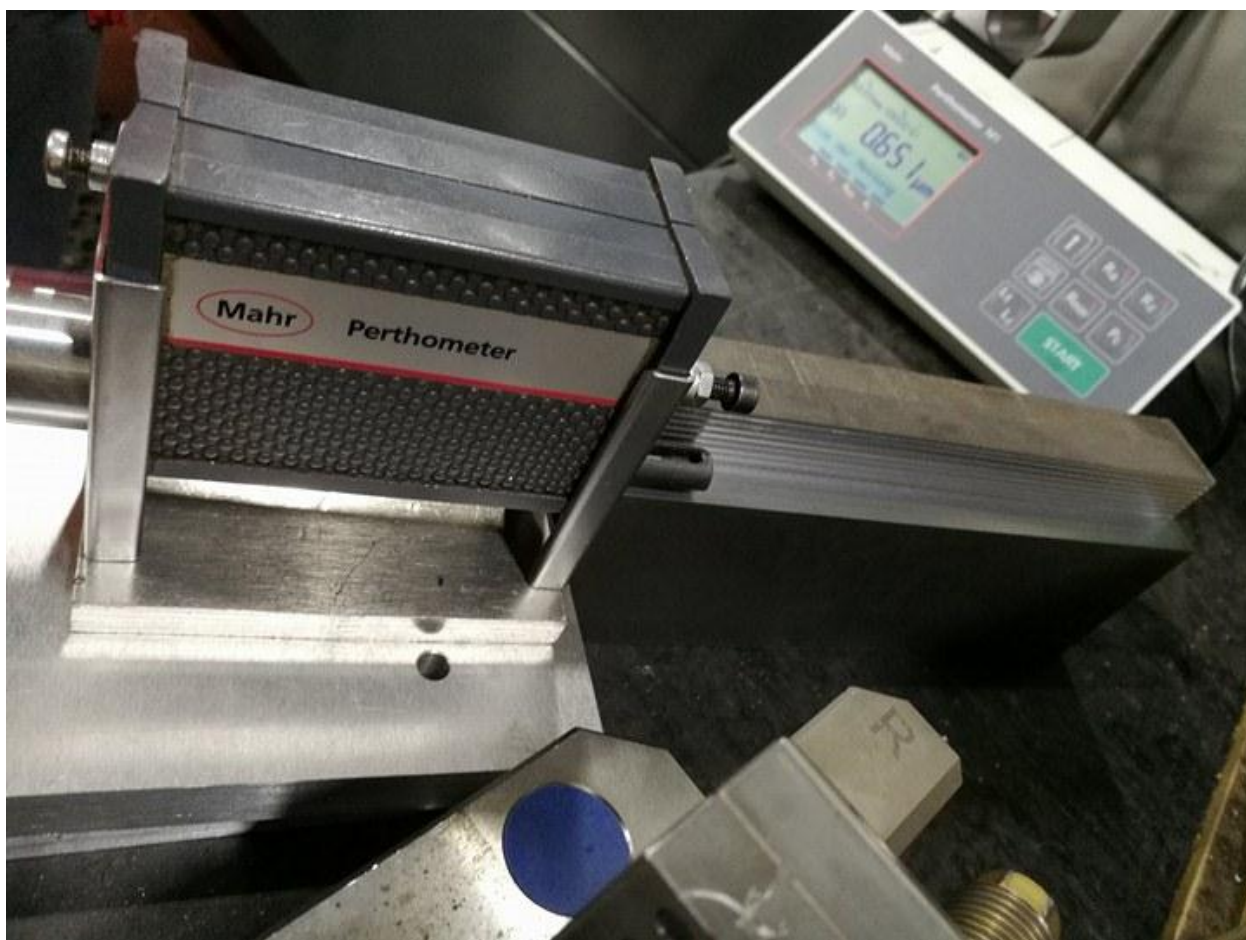
Slika.4.9 Uređaj za mjerenje hrapavosti korišten u testiranju.
