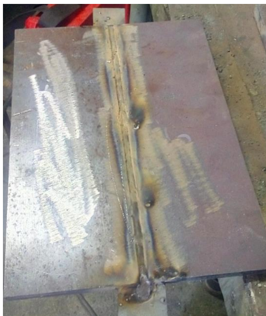
Slika 55. Gotov zavareni spoj, prije četkanja
