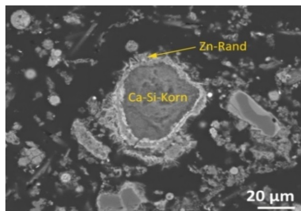
Abbildung 7-4: Ca-Si-Korn umgeben von neu gebildeten, fiederartige Zn-Ränder in FKZUC nach einer Extraktionsdauer von 8.5 h mit \text{H}_2\text{O} .
