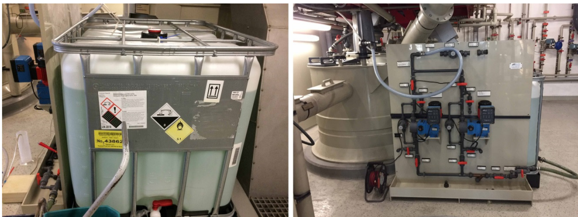
Abbildung 8-8: Versuchseinrichtung der \text{H}_2\text{O}_2 -Zugabe während dem FLUWA-Betrieb bei der KVA Linth.
