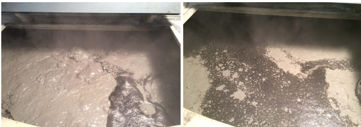
Abbildung 8-11: Durchmischung der Aschesuspension bei maximaler Luftindüsung (links) und reduzierter Luftindüsung (rechts) in Behälter 2.
