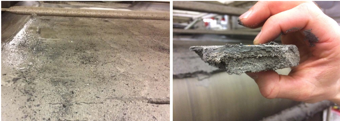
Abbildung 8-10: (links) Veränderte Filtrationsleistung beim Einsatz von \text{H}_2\text{O}_2 . (rechts) Feinkörnige Schicht (Metallhydroxide) auf der Oberfläche des Filterkuchens, welche die Filtration beeinflussen.
