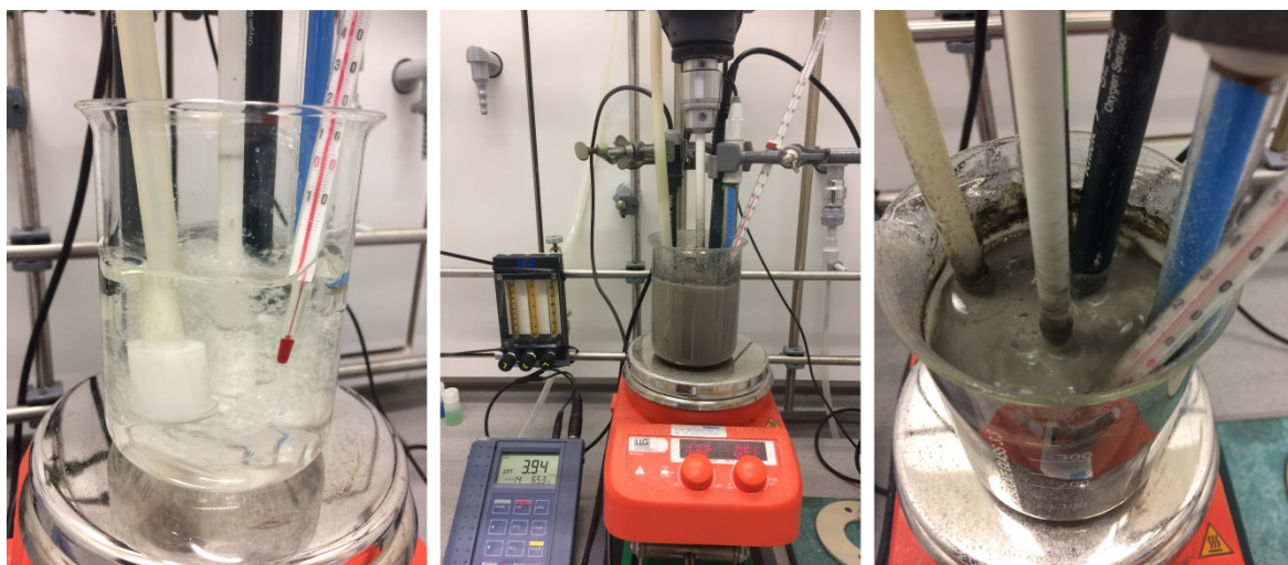
Abbildung 8-2: Versuchseinrichtung mit Luftfeindüsung und pH, Eh-Monitoring.
