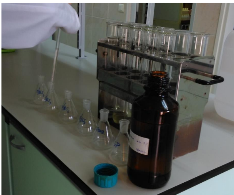
Slika 15. Dodavanje 5 ml borne kiseline u tikvice od 100 ml prije destilacije
