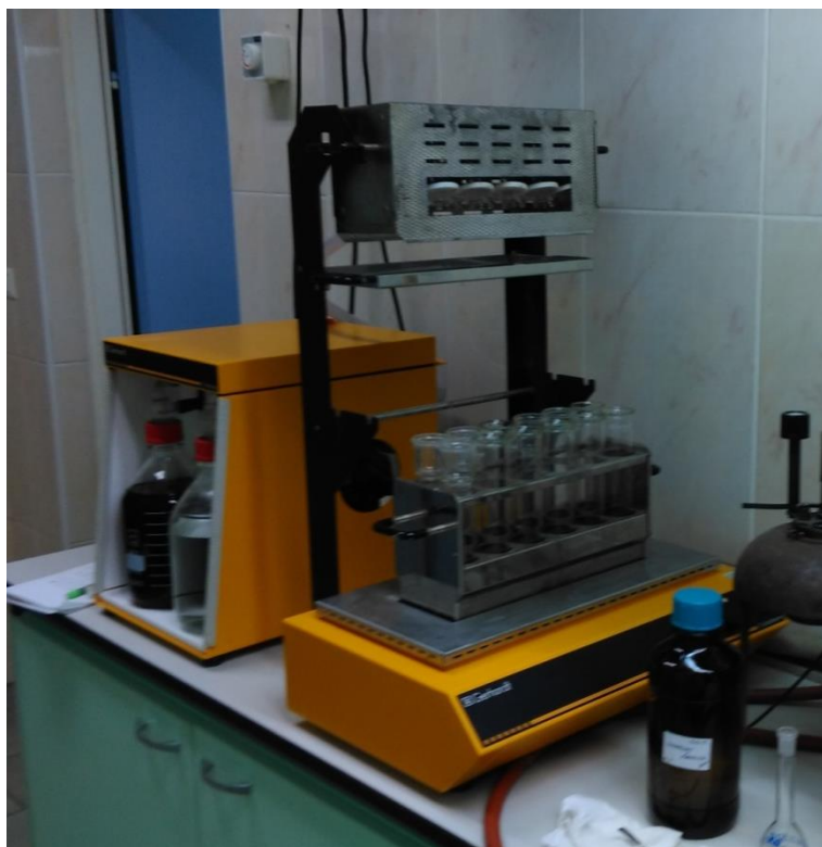
Slika 10. Aparatura za razaranje uzoraka po Kjeldahlu
