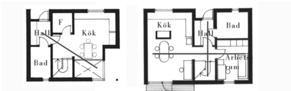
Axialitet och riktningar i entréplan 5 och 4 rum och kök. Skala 1:200. Möblerade planer från intervju 4 till vänster, och intervju 2 till höger.
