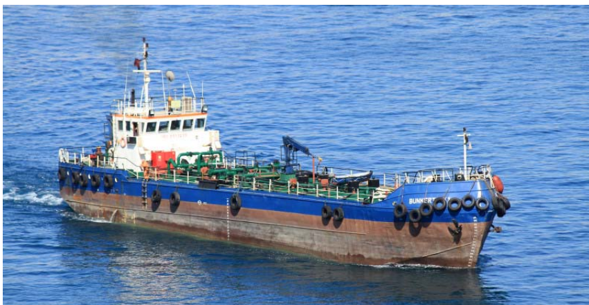
Kuva 7.3. Tyypillinen bunkrausalus, pituus 48 m, leveys 8 m syväys 4,3 m. 576 GT: (Kuva: Brian Crocker 2012, http://www.shipspotting.com/gallery/photo.php?lid=1560381 )
