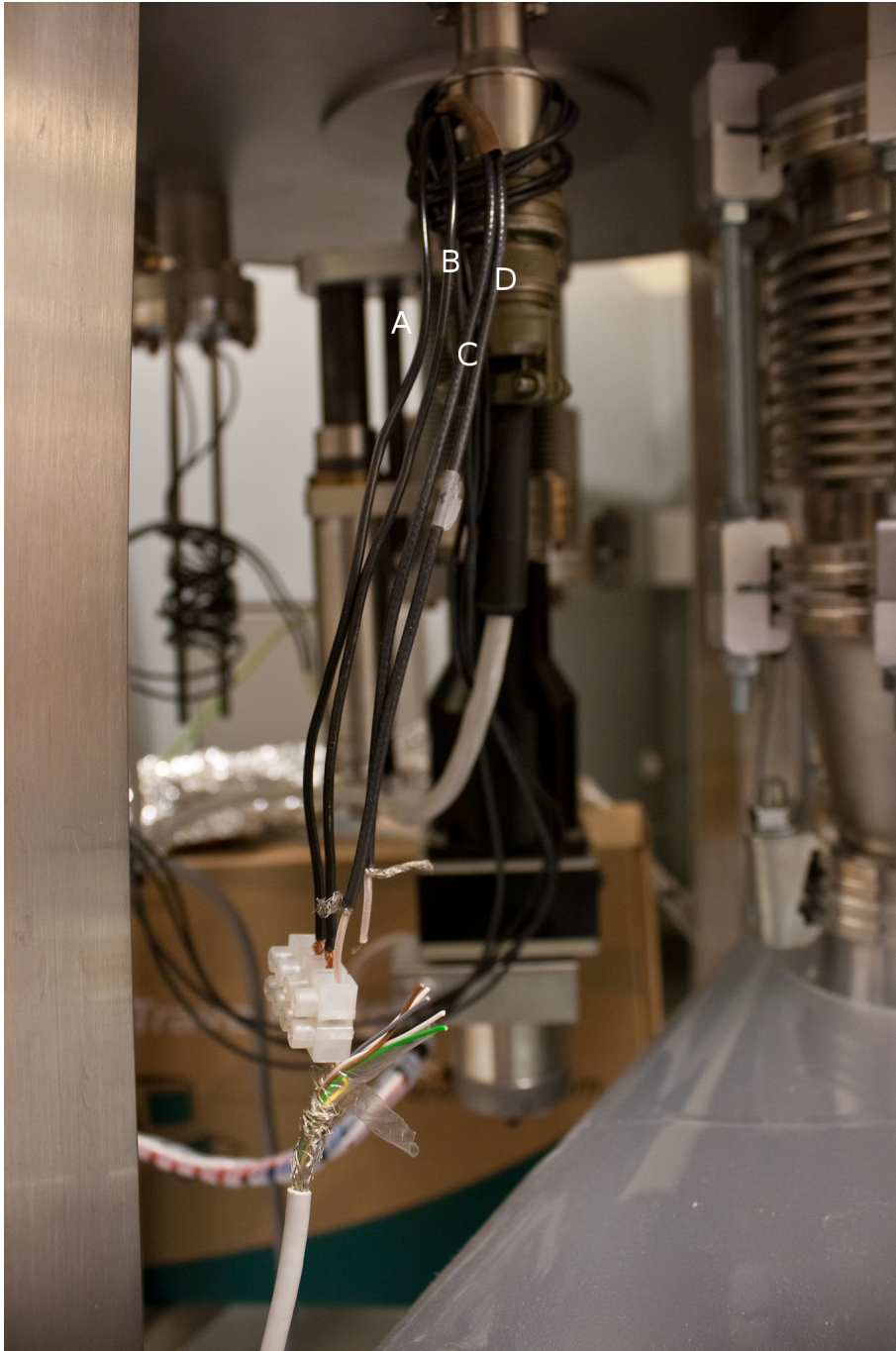
Kuva 40. Hall-anturin läpivientien ulkopuolelle jäävien johtimien järjestys.
