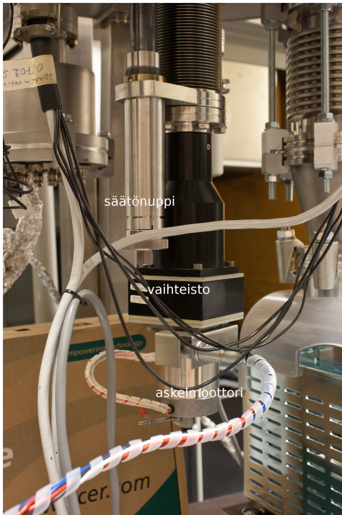
Kuva 36. Askelmoottori ja vaihteiston tyhjiökammion ulkopuolelle jäävä osa. Kuvaan on myös merkitty akselin korkeuden säätönuppi.
