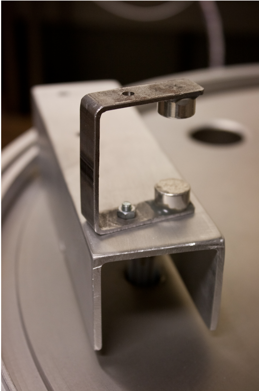
Kuva 13. Neodymium-magneetit, joiden välistä Hall-anturi kulkee. Toisin sanoen kuvassa on kalibrintipiste.
