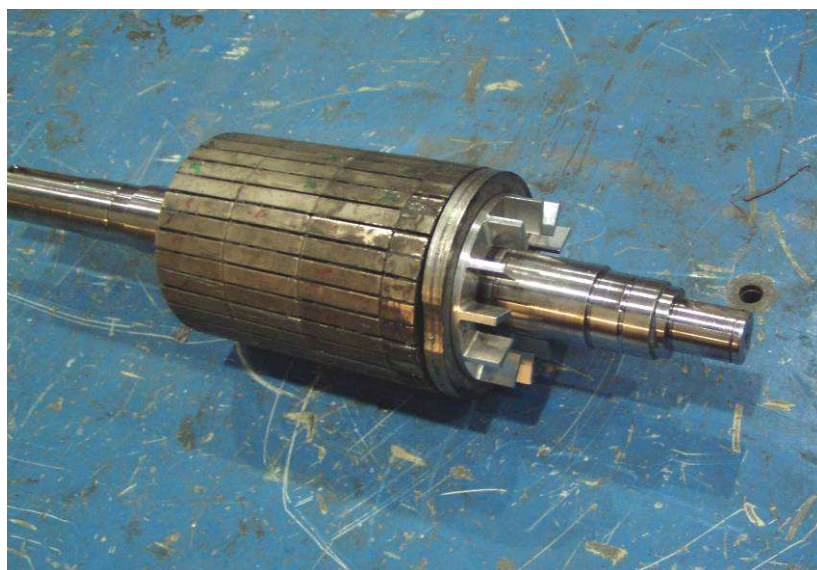
Kuva 44. Pääroottori sekä tuuletinroottori koneen akselilla.
