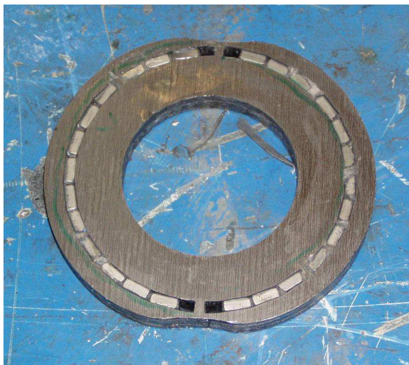
Kuva 43. Uusi tuuletinroottori A, laakeri ja tuuletinsiivet vielä puuttuvat.
