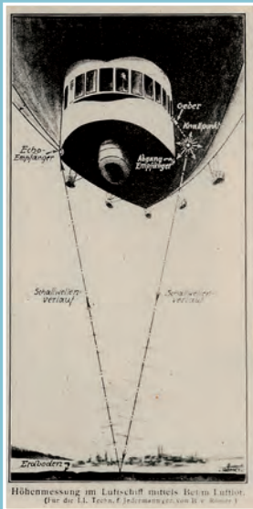
Höhenmessung im Luftschiff mittels Behm-Luftlot
