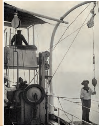
Lotmaschine an Bord der „Valdivia“ (1898/99)
