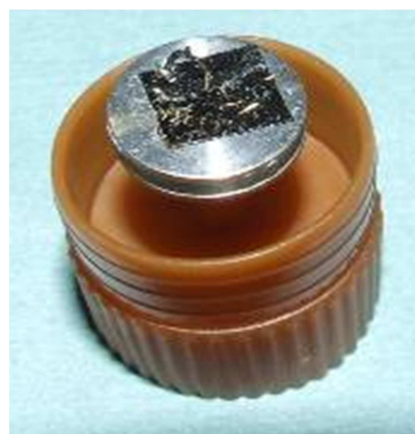
Figura 5.10-“Trappole” utilizzate per la raccolta della contaminazione
