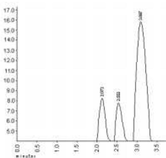
A) El primer pico con un tiempo de retención de 2.0 min corresponde a ACET, el segundo con un tiempo de 2.37 min a tolazamida (estándar interno) y el tercero con un tiempo de 3,0 min a TB.
