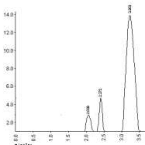
B) El primer pico con un tiempo de retención de 2,1 min. corresponde a PROP, el segundo con un tiempo de retención de 2,37 a tolazamida (estándar interno) y el tercero con un tiempo de 3,0 a TB.
