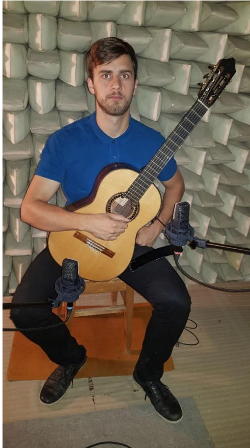
Sl. br. 10 Prikaz postave gitare i mikrofona za prva 3 mjerenja
