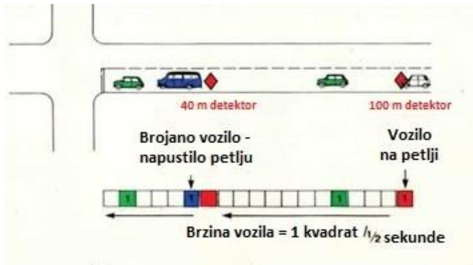
Slika 1. Prikaz detekcije vozila [3]
