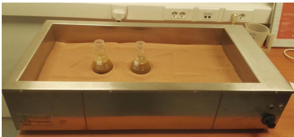
Slika 4-5 Pje-anoj kupelj za provođenje ispitivanja
