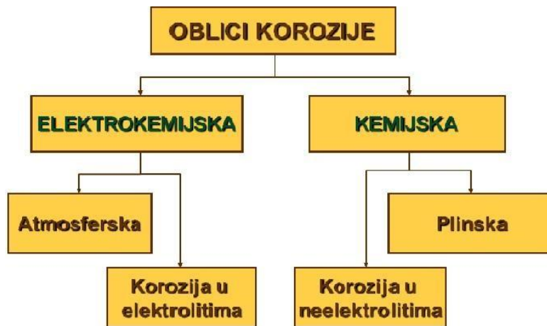
Slika 3.2. Shematski prikaz oblika korozije, [4]
