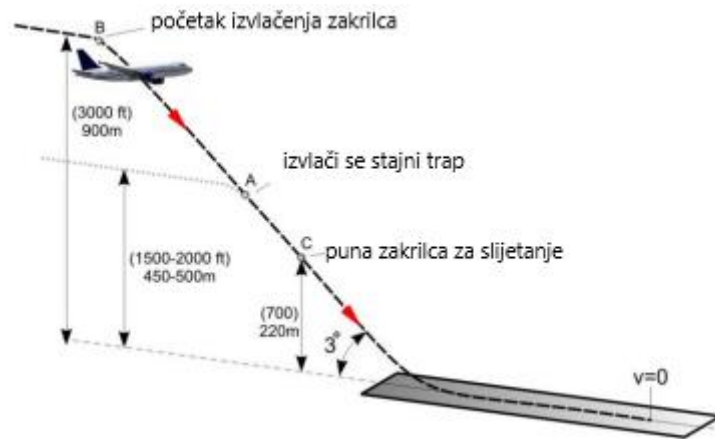
Slika 8. Postupak Lufthansa-e, [9]
