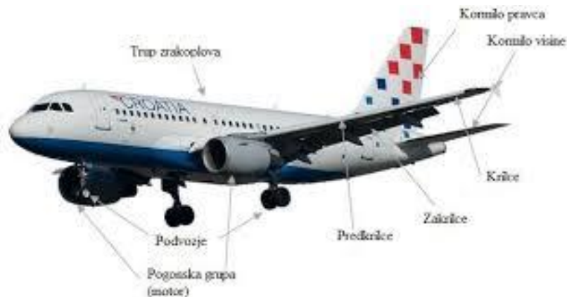
Slika 2. Prikaz izvora buke na zrakoplovu, [18]
