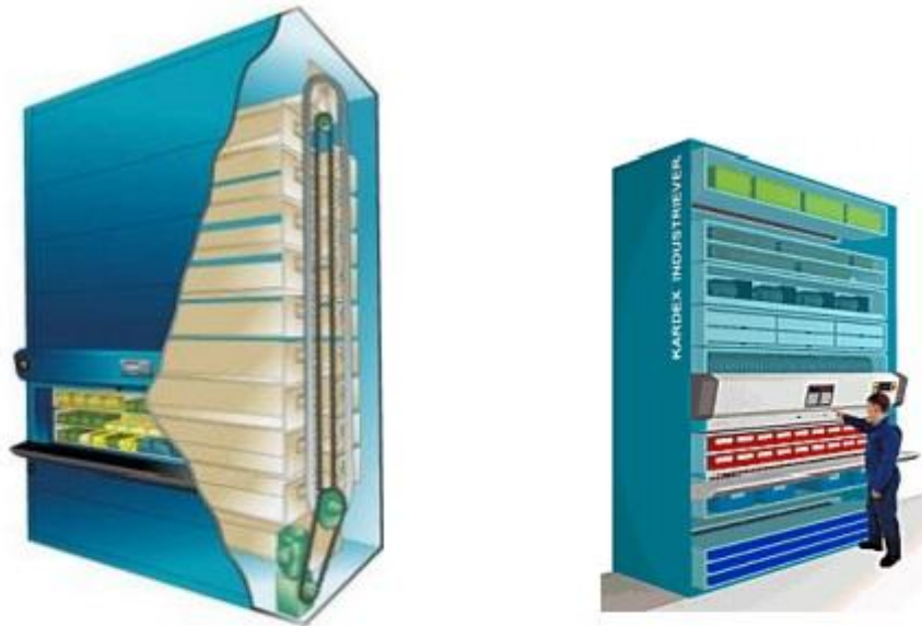
Slika 11. Komisioniranje po principu „roba k čovjeku“
