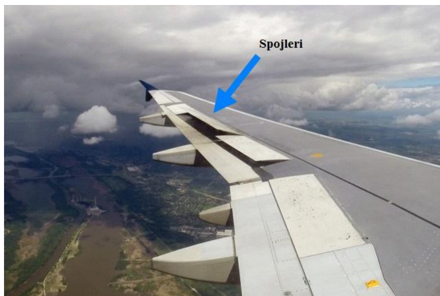
Slika 26 - Aktivirani spojleri na zrakoplovu A320
