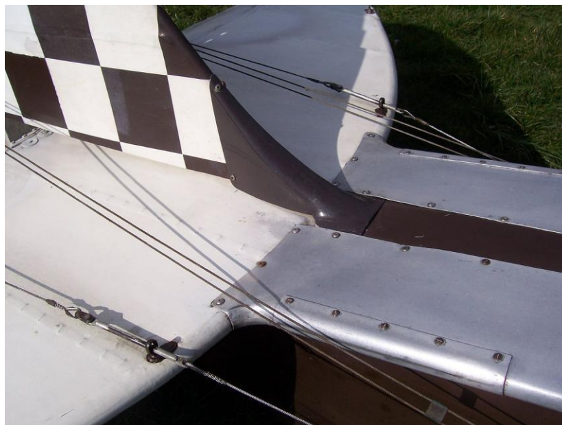
Slika 31 - Kablovi kojima se prenosi sila na kormila smjera i dubine na zrakoplovu de Havilland DH.82 Tiger Moth
