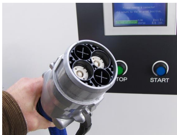
Slika 9. CHAdeMO priključak za brzo punjenje električnog vozila Izvor: http://www.voltrek.com/standards/
