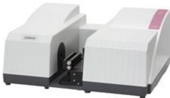
Slika 13. UV/Vis spektrofotometar Scinco S-3100, Scinco CO., LTD
