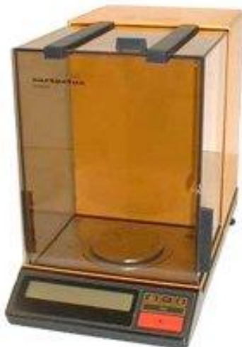
Slika 11. Analitička vaga Sartorius R200D
