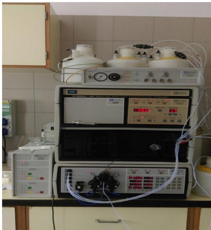
Slika 14. Ionski kromatograf Dionex DX 300, Dionex Corporation, Kalifornija
