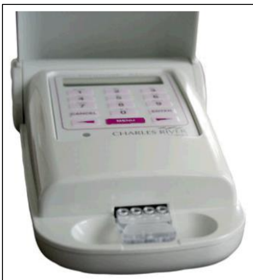
Slika 8. Prijenosni spektrofotometar (PLIVA, 2015)
