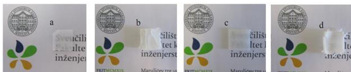
Slika 29 Prikaz prozirnosti uzorka bubrenih u sljedećim otapalima: a) THF b) aceton c) DMSO d) DMF
